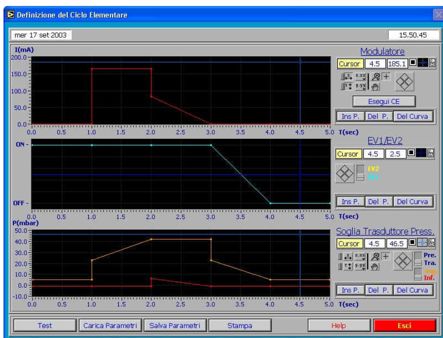
Fig. 2 - Interfaccia utente: pannello per la definizione del ciclo elementare
