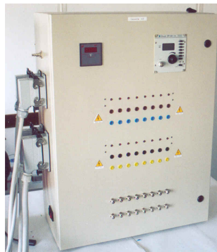
Fig. 1 - Foto di una delle 6 cassette utilizzate per il controllo delle prove vita.
