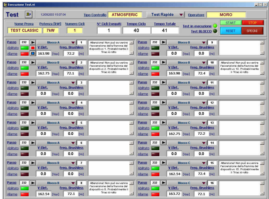
Fig. 3 - Pannello di gestione del Test. Oltre alle informazioni generali e ai pulsanti di gestione, per ogni postazione, sono disponibili gli stati logici di abilitazione e di errore, le grandezze elettriche rilevate, il blocco selezionato e i messaggi.
